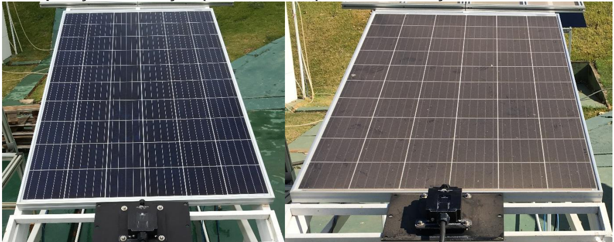
Figura 72. Estação de sujidade tecnologia silício cristalino. À esquerda, início de operação da estação (dia 13/03/2017). À direita, estação no dia 15/09/2017
