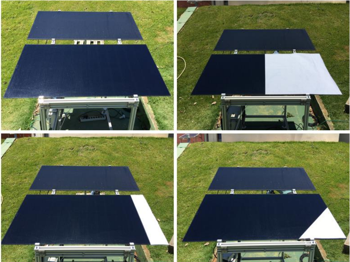
Figura 30. Simulação de deposição de sujidade não uniforme em um módulo de telureto de cádmio utilizando-se amostras de papéis
