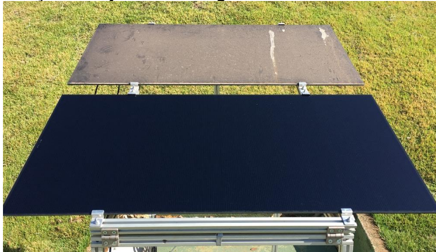
Figura 73. Estação de sujidade tecnologia telureto de cádmio no dia 15/09/2017
