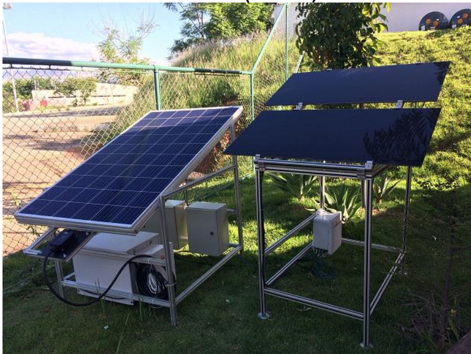
Figura 37. Estações de sujidade tecnologias de silício (à esquerda) e telureto de cádmio (à direita)
