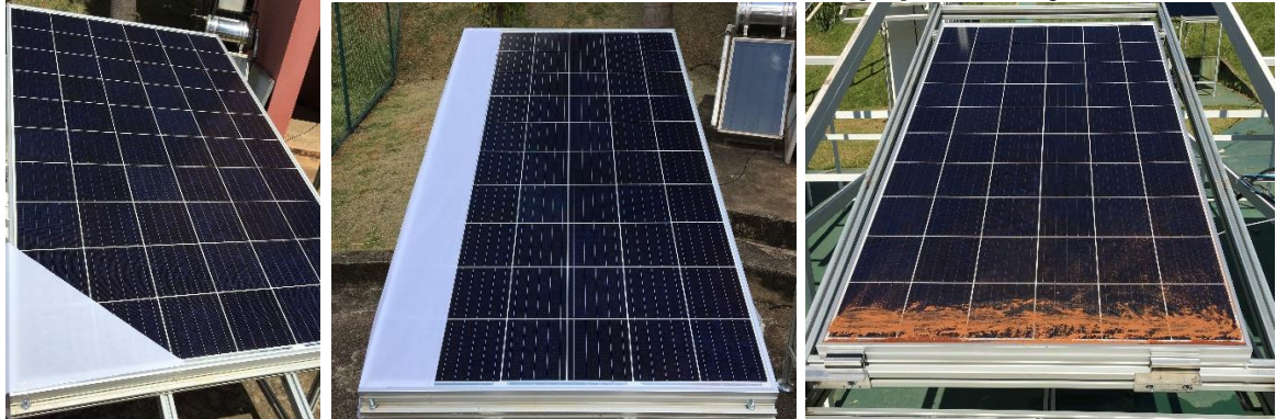
Figura 29. Simulação de deposição de sujidade uniforme e não uniforme em um módulo de silício utilizando-se amostras de papéis e sujidade real
