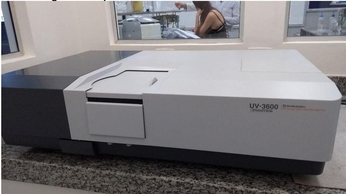
Figura 31. Espectrofotômetro Shimadzu modelo UV-3600
